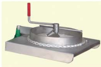
Dettaglio dello spalmatore manuale, che permette di dosare la pasta sui fiscoli.
